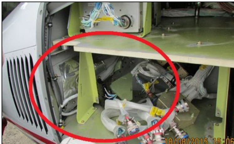
Fotografía N°10. El área muestra la gran cantidad de material que proviene del anidamiento del tren.
