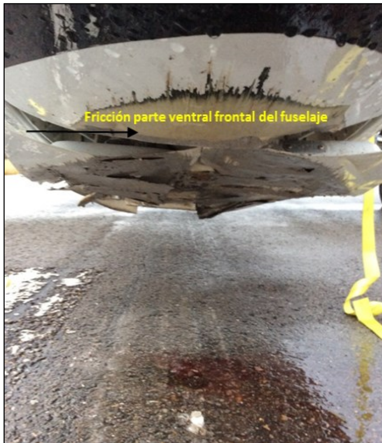
Fotografía N°2. Condición del fuselaje de la aeronave N188RU
