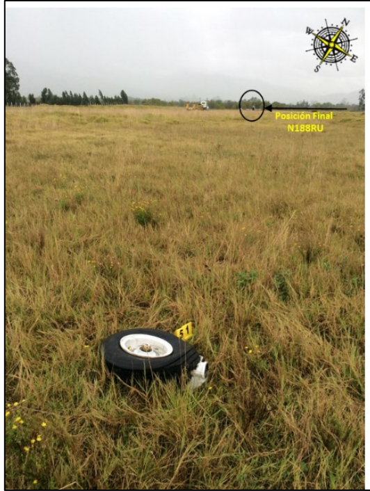
Fotografía N°8. Llanta tren de nariz ubicada a 30 mts zona de seguridad pista 04
