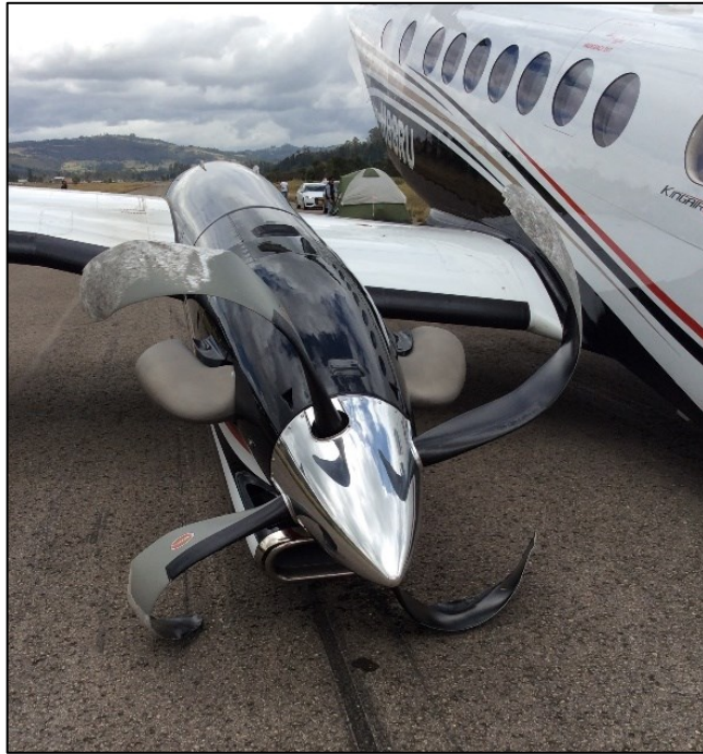
Fotografía N°3. Condición final motor derecho (R)
