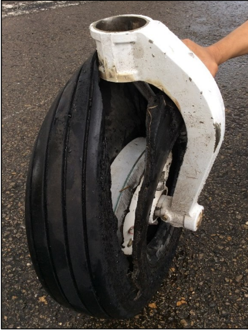
Fotografías N° 5 y 6. Condición final estructura tren de nariz y llanta de nariz
