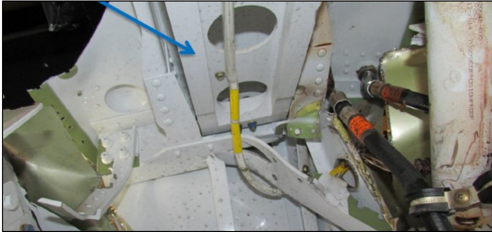
Fotografía N°9. Anidamiento y brazo de arrastre superior tren de nariz
