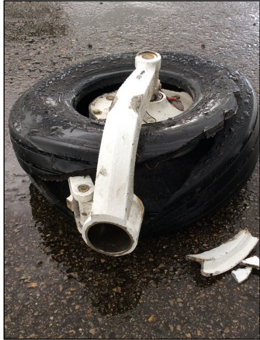
Fotografías N° 5 y 6. Condición final estructura tren de nariz y llanta de nariz
