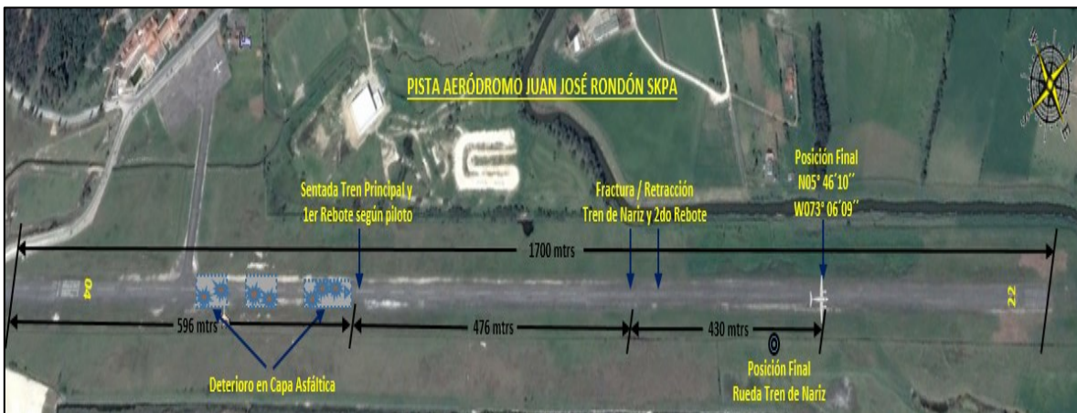
Croquis de la Secuencia de Aterrizaje - Ubicación final de la aeronave y evidencias en pista SKPA
